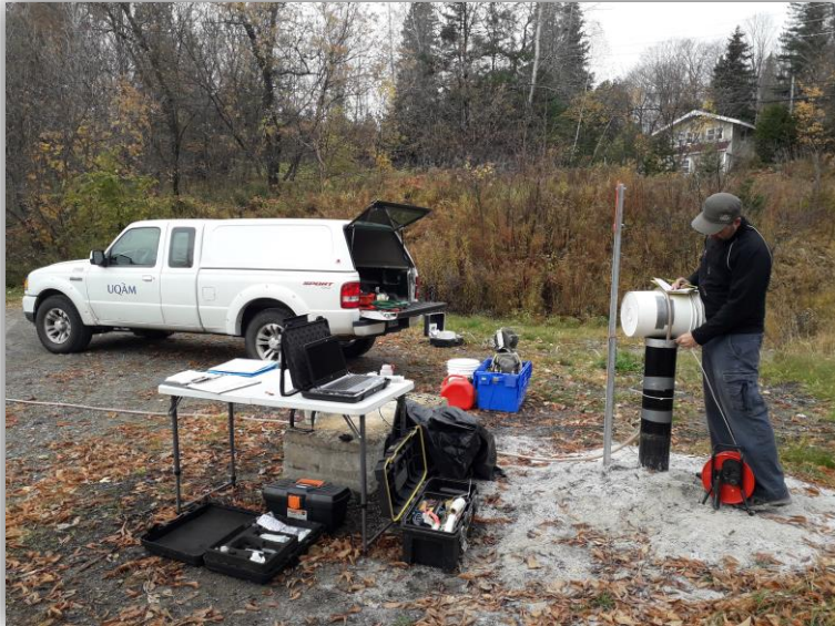
Essai de pompage à un puits nouvellement foré
