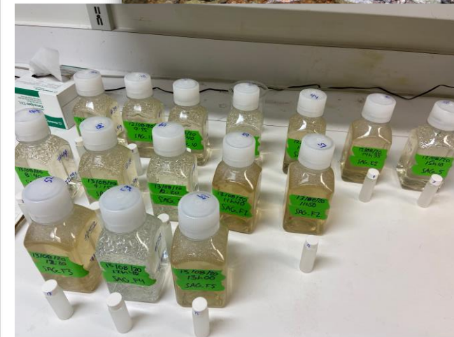
Échantillons d'eau de surface pour analyses Radon-222 (Géotop-UQAM)
