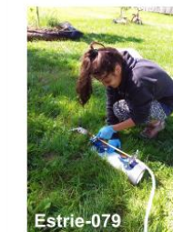
Estrie-079 Remplissage d'un tube de cuivre pour l'analyse des gaz nobles
