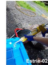
Estrie-022 Séparation des espèces d'arsenic par filtration et piégeage sur cartouches
