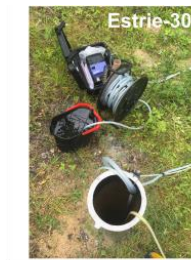
Estrie-300 Échantillonnage d'un puits du RSESQ avec une pompe submersible
