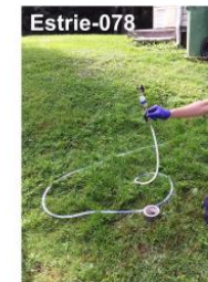
Estrie-078 Remplissage d'une ampoule métallique pour l'analyse des CFC/SF 6
