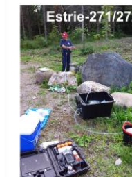
Estrie-271/272 Ajustement du débit de pompage d'un puits privé pour l'échantillonnage
