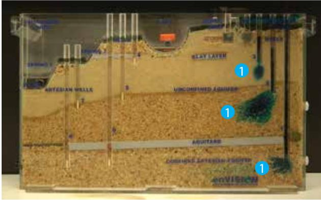
2 L'écoulement progresse de l'amont vers l'aval. Les eaux des couches supérieures de sable fin et de sable grossier de l'aquifère à nappe libre se mélangent : ces couches sont en lien hydraulique. 3 L'eau de l'aquifère à nappe captive inférieur ne se mélange pas avec celle de l'aquifère supérieur. L'aquitard (en gris) agit comme une barrière naturelle qui isole l'eau de l'aquifère à nappe captive.
