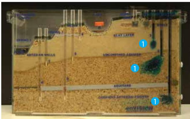
4 Il y a pompage dans le puits d'alimentation n°8. L'eau puisée est colorée, indiquant qu'elle provient réellement de l'amont. 5 L'écoulement est plus rapide dans l'aquifère à nappe captive inférieure, indiquant une conductivité hydraulique plus élevée.
