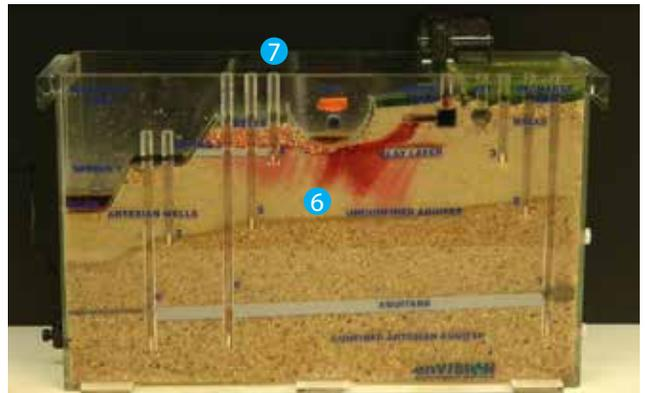
8 En atteignant la couche de sable plus grossier à la base de l'aquifère à nappe libre, l'écoulement de l'eau contaminée se fait plus rapidement. 9 Les puits n°5 et n°7 sont maintenant contaminés.
