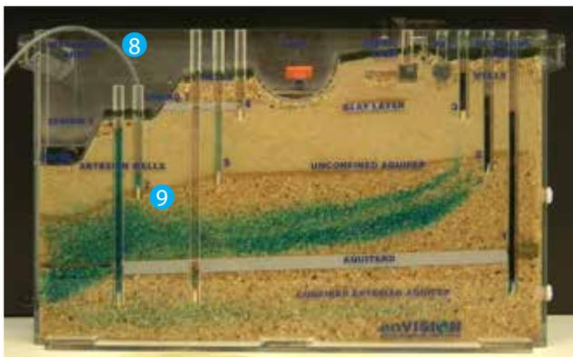
2 L'écoulement progresse de l'amont vers l'aval. Les eaux des couches supérieures de sable fin et de sable grossier de l'aquifère à nappe libre se mélangent : ces couches sont en lien hydraulique. 3 L'eau de l'aquifère à nappe captive inférieure ne se mélange pas avec celle de l'aquifère supérieur. L'aquitard (en gris) agit comme une barrière naturelle qui isole l'eau de l'aquifère à nappe captive.
