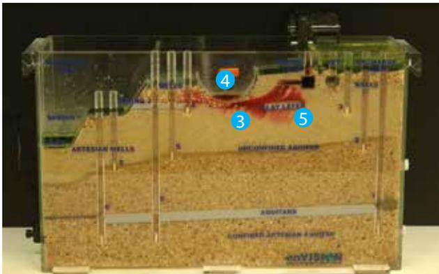
6 Le volume d'eau souterraine contaminée est de plus en plus important. 7 Le puits n°4 est maintenant contaminé.
