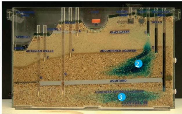
4 Il y a pompage dans le puits d'alimentation n°8. L'eau puisée est colorée, indiquant qu'elle provient réellement de l'amont. 5 L'écoulement est plus rapide dans l'aquifère confiné inférieur, indiquant une conductivité hydraulique plus élevée.
