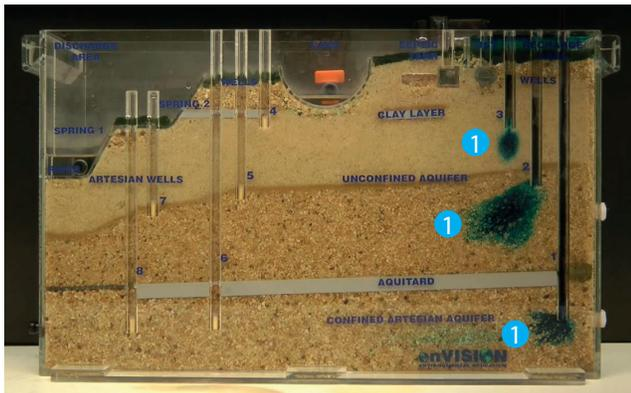
2 L'écoulement progresse de l'amont vers l'aval. Les eaux des couches supérieures de sable fin et de sable grossier de l'aquifère non confiné se mélangent : ces couches sont en lien hydraulique. 3 L'eau de l'aquifère confiné inférieur ne se mélange pas avec celle de l'aquifère supérieur. L'aquitard (en gris) agit comme une barrière naturelle qui isole l'eau de l'aquifère confiné.
