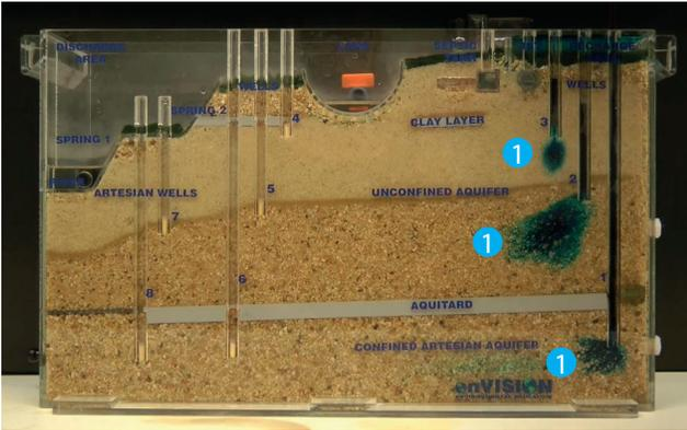
④ Il y a pompage dans le puits d'alimentation n°8. L'eau puisée est colorée, indiquant qu'elle provient réellement de l'amont. ⑤ L'écoulement est plus rapide dans l'aquifère inférieur, indiquant une conductivité hydraulique plus élevée.
