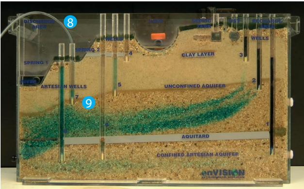
L'écoulement progresse de l'amont vers l'aval. ② Les eaux des aquifères non confinés de sable fin et de sable grossier se mélangent. Les aquifères sont en lien hydraulique. ③ L'eau de l'aquifère confiné ne se mélange pas avec celle des aquifères sus-jacents. L'aquitard agit donc comme une barrière naturelle qui isole l'eau de l'aquifère confiné.
