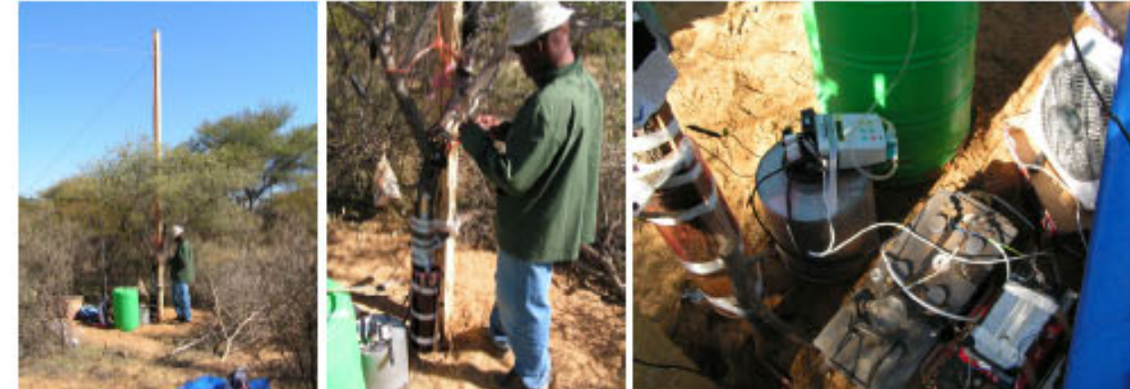
Figure 5: in-situ Roberts: (gauche) mât de soutien de l'arbre, réservoir d'alimentation (en vert) pour la pompe, (centre) haut: arrimage de l'arbre, bas: cylindre d'acrylique solidaire de l'arbre hors sol, (droite) de gauche à droite: cylindre d'acrylique, pompe, réservoir, accumulateur, séquenceur.
