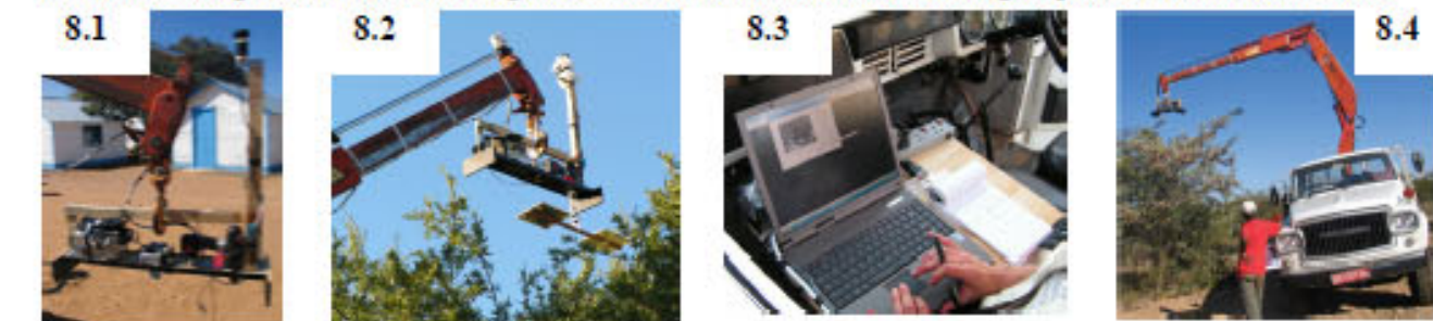
Figure 8: acquisition de signature spectrale sur les 9 espèces à l'étude: (8.1) plateforme semi-assemblée avec capteurs Skye 4 bandes, en haut du bras vertical: vers le haut et au centre de la plateforme: vers la cible, caméra 3 bandes Vert, Rouge et proche-infrarouge ("Agricultural Digital Camera"), enregistreur numérique, télécommande de panneau et interface USB, (8.2) essais préliminaires avec panneaux de calibration Kodak, (8.3) contrôle de la cible perçu par la caméra, télécommande de panneau de calibration, gestion des sites de mesures, (8.4) la grue elle-même est commandée hydrauliquement - conception classique - à proximité du poste du conducteur (conduite à droite).
