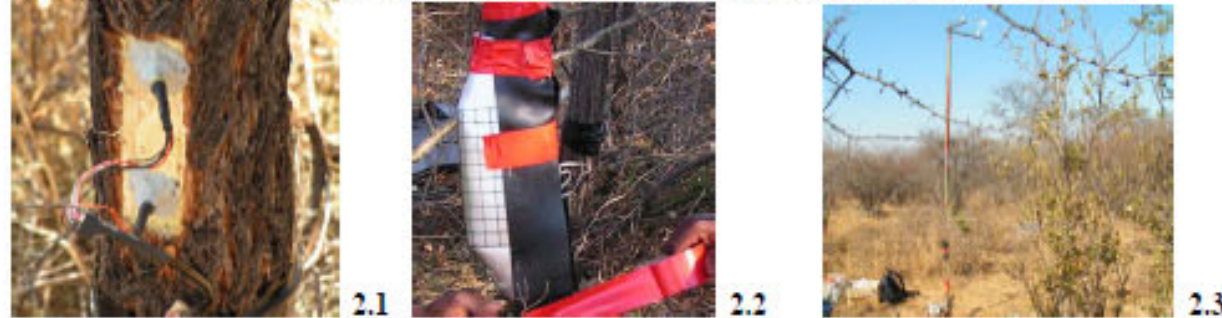
Figure 2: (1) sonde Granier (TDP), (2) écran thermique, (3) mât d'acquisition: anémomètre et pyranomètre au sommet, hygromètre et température de l'air, enregistreur numérique (DataHog2) à la base, le panneau solaire se distingue difficilement au sol à droite du mât. (à noter: épines d'acacias partout!)
