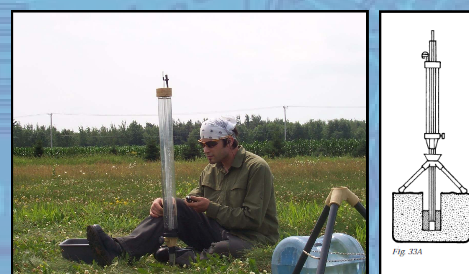
Figure 3: À gauche, prise de mesure avec le perméamètre de Guelph et à droite un schéma de l'instrument de mesure
