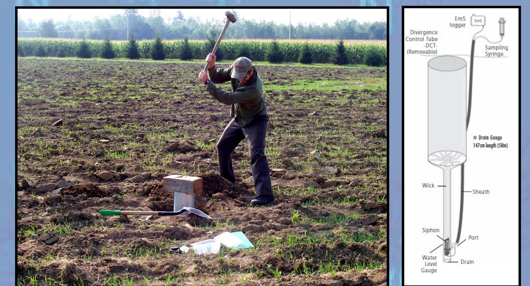
Figure 4: À gauche, installation d'un lysimètre passif et à droite, schéma de l'instrument de mesure.
