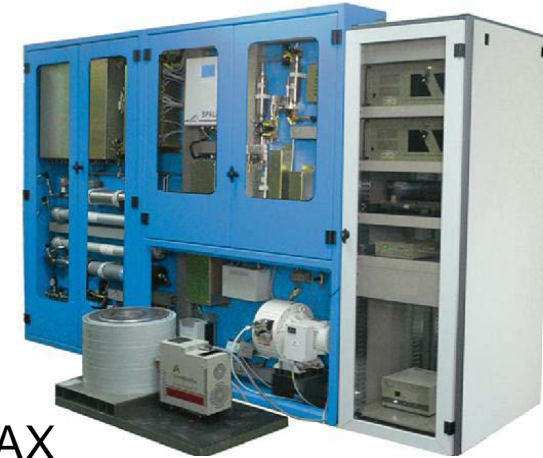
Système de Prélèvement Automatique en Ligne avec l'Analyse du Xénon
