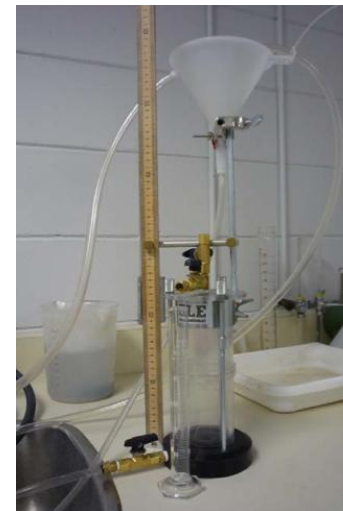
Perméamètre K-605A (Charge constante et variable)
