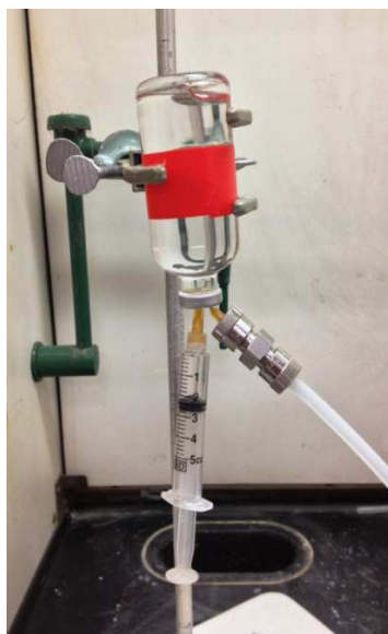
Figure 7. Dispositif de récupération du gaz.
