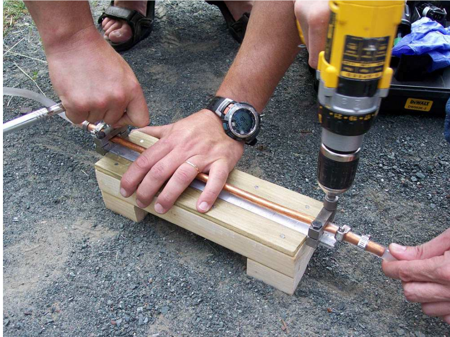
Figure 6. Échantillonnage pour les gaz rares : serrage des mâchoires pendant l'échantillonnage d'eau souterraine avec un tube en cuivre.
