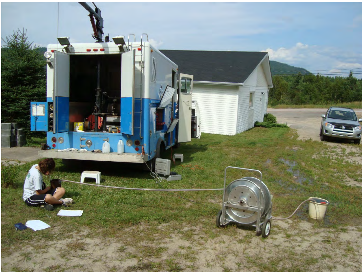
Photo 2-2 : Diagraphie géophysique en forage à Hébertville, dans un puits inutilisé.
