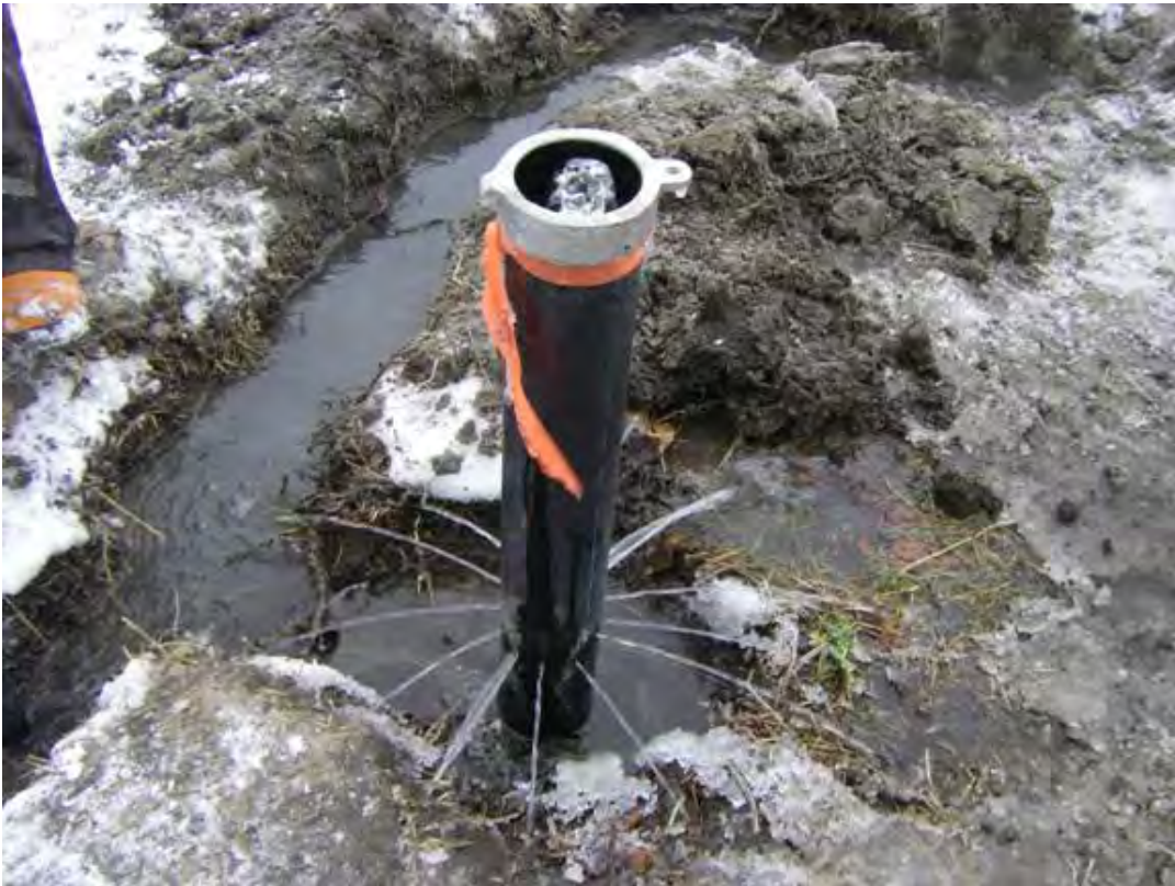
Photo 2-8 : Piézomètre de 5 cm de diamètre captant une nappe captive artésienne jaillissante sur le site d'investigation de Métabetchouan-Lac-à-la-Croix.
