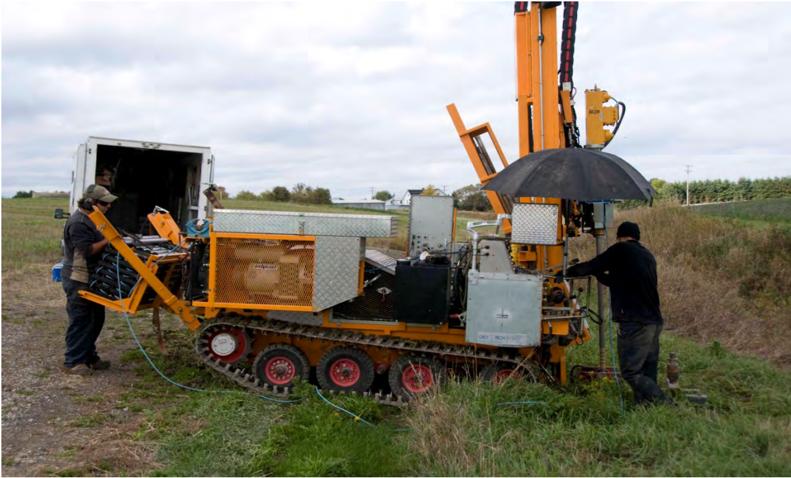
Photo 2-7 : Levé au piézocône réalisé dans le secteur de Métabetchouan-Lac-à-la-Croix.
