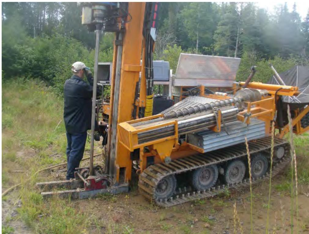
**Figure 2-5 : Foreuse Geotech 605D en opération.**
